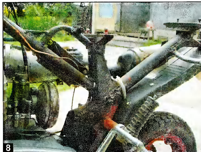
8 Сиденье на мотоцикле сделано съемным, а не откидным, как на мопеде. Подножки для пассажира крепятся к раме шпилькой крепления амортизаторов.
