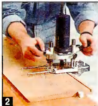
2 В боковых стенках четырех корпусных элементов с помощью фрезерной машинки выбирают пазы для задних стенок.
