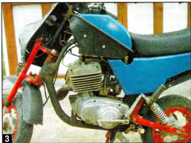
3 Декоративные панели на бензобаке зрительно увеличивают его объем и не мешают доступу к свече зажигания.
