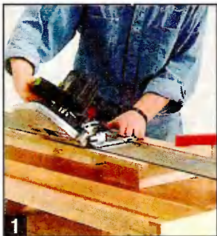
1 После раскроя заготовок некоторые их кромки (см. рис. на с. 14) скашивают.
