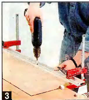
3 В перегородках с шагом 32 мм сверлят ряды отверстий, пользуясь сверлильным кондуктором.
