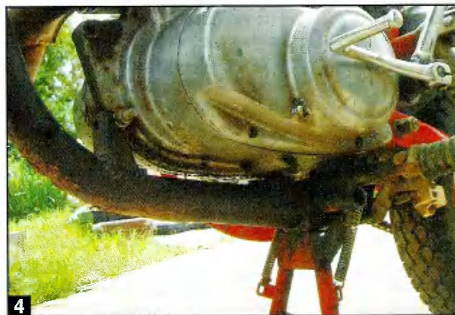
4 Спереди двигатель к раме крепится на одной проушине. Подножки водителя перенесены выше, чтобы было удобно переключать передачи.
