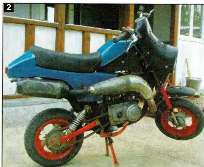
Мини-мотоцикл «Конек-Горбунук»: рама, сиденье, бензобак, колеса, амортизаторы и передняя вилка — от рижского мопеда «Стелла»; двигатель — от мотоцикла «Минск»; фара, руль, корпус спидометра и передний обтекатель — от грузового мотороллера «Муравей».
