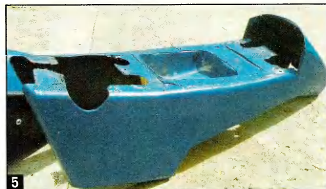
5 Декоративный кожух-обтекатель, закрывающий заднюю часть рамы, выклеен из стеклопластика.
