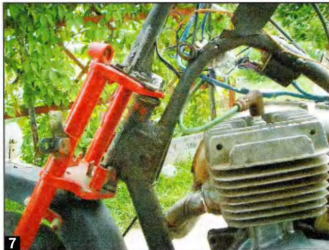
7 Подрамник из трубы \varnothing 1,5 дюйма приварен к втулке вилки руля. Стойка руля крепится к передней вилке четырьмя болтами. Дуга для крепления бензобака придает дополнительную жесткость раме мотоцикла на изгиб. На ней же установлена катушка зажигания и коммутатор.
