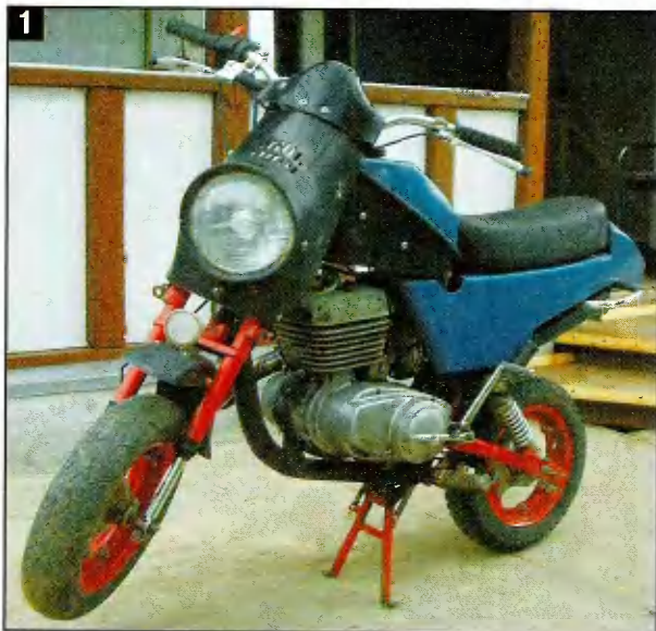
Мини-мотоцикл «Конек-Горбунук»: рама, сиденье, бензобак, колеса, амортизаторы и передняя вилка — от рижского мопеда «Стелла»; двигатель — от мотоцикла «Минск»; фара, руль, корпус спидометра и передний обтекатель — от грузового мотороллера «Муравей».
